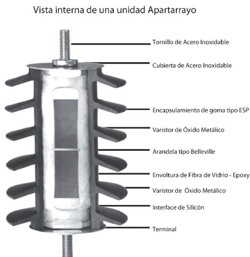
Figura 41 ADOM: Apartarrayo de óxidos metálicos
