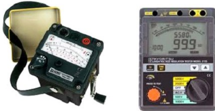
Figura 74 Medidores de resistencia de aislamiento de distintas épocas.
